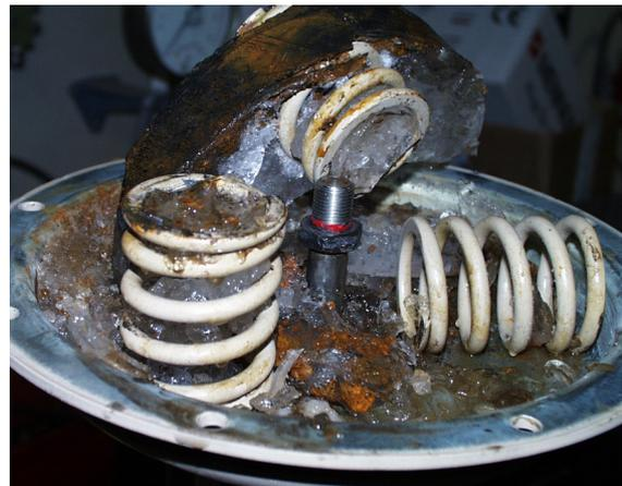
Eingefrorener Stellantrieb (Laterne) eines Regelventils. Durch die Entlüftung wurde ständig feuchte Luft (dampfbelastete Atmosphäre) ins innere transportiert, die dann auskondensiert ist und zum Versagen durch Eisbildung im Winter führte.
