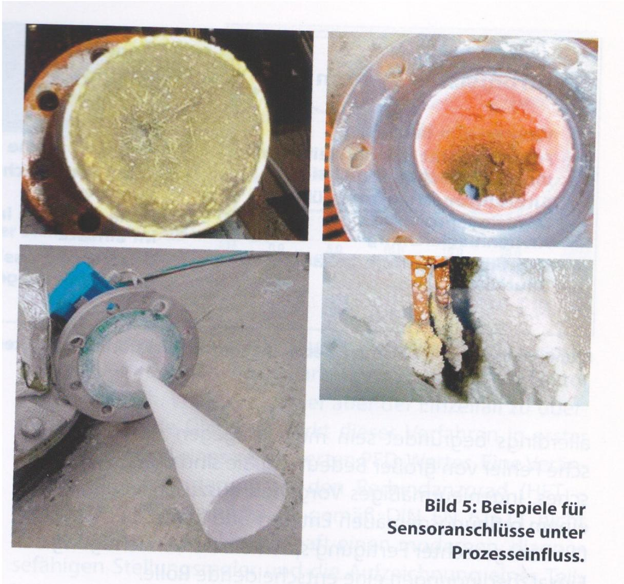
Bild oben links: Ablagerungen an der Membran eines Druckmessumformers mit vorgelagerter Membran (Tubus).
