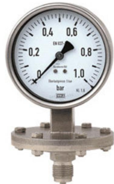
Plattenfedern sind kreisförmige, gewellte Membranen. Sie werden zwischen zwei Flansche entweder am Rand eingespannt oder verschweißt und einseitig vom Druck des Messstoffes beaufschlagt. Die dadurch hervorgerufene Durchbiegung wird als Maß für den Druck genutzt und über ein Zeigerwerk zur Anzeige gebracht.
