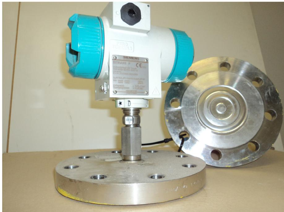
Zum Anbau an einen Stutzen, oder als Boden-druckmessung (Niveau) an einem Behälter.
