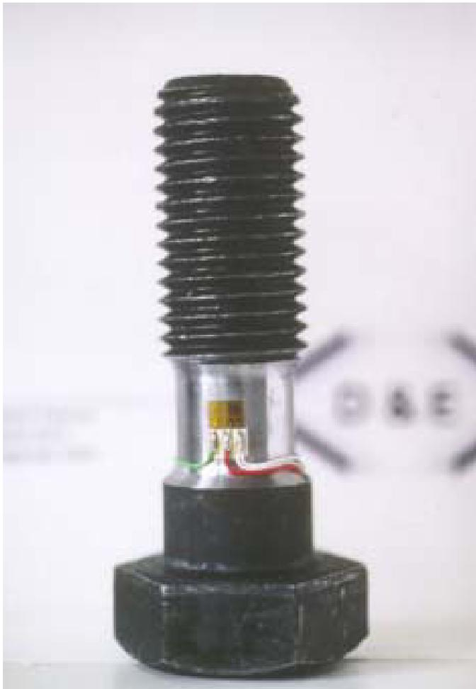
Zugkraftmessung in einer Maschinenschraube
