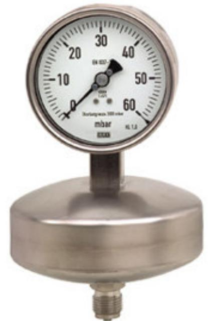
Die Kapselfeder besteht aus zwei kreisförmigen, gewellten, am Rand druckdicht zusammengefügt Membranen.. Der Druck wirkt auf die Innenseite dieser Kapsel und die erzeugte Hubbewegung wird als Maß für den Druck über ein Zeigerwerk zur Anzeige gebracht.
