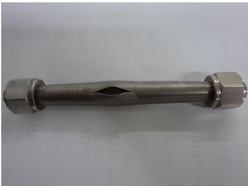
12mm Edelstahlleitung mit einer Wandstärke vom 1 mm bei einem Druck von 1030 bar aufgeplatzt.
