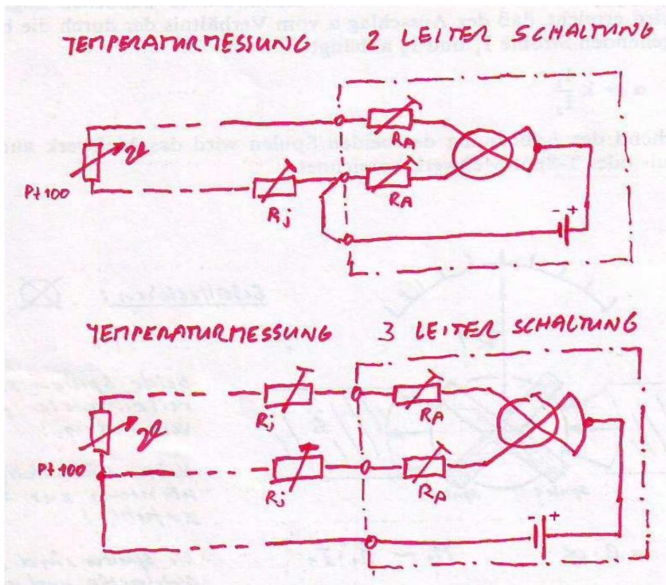
Werden beide Stromzweige von einer Spannungsquelle gespeist und ist der Widerstand in einem Zweig konstant und im anderen veränderlich, so hängt der Zeigerausschlag nur von der Größe des veränderlichen Widerstandes ab (Schaltung des Widerstandsthermometers, Pt100 / Ni100/ Pt1000).
