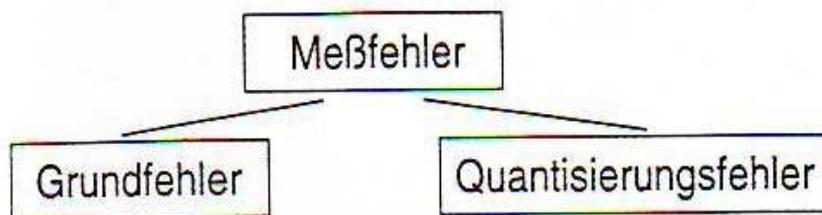
Der Grundfehler entsteht durch die toleranzbehafteten Bauteile des Analog-Digital-Wandlers; er wird in Prozent vom angezeigten Messwert angegeben und beträgt meist 0,5% bis 1%.
