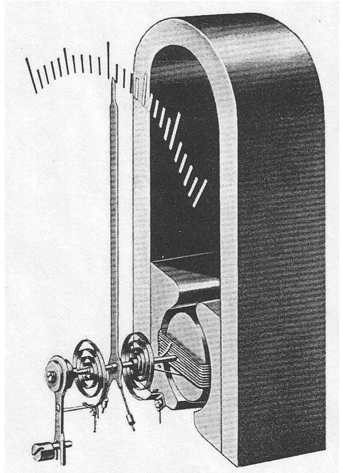
Das Drehspul-Messwerk ist das messempfindlichste elektrische Messwerk. Ströme in der Größenordnung von Milliardstel Ampere können damit gemessen werden. Durch Vorschalten eines Gleichrichters oder eines Thermoumformers sind auch Wechselströme bis zu hohen Frequenzen messbar. Daher werden Wechselstrommessungen vielfach auf Gleichstrommessungen zurückgeführt, um so die hohe Empfindlichkeit des Messwerks auszunutzen.
