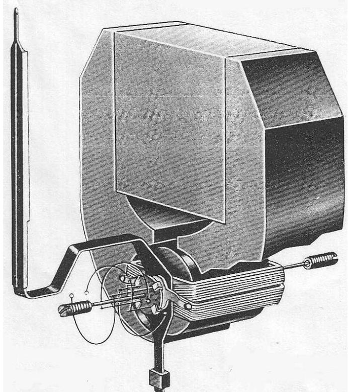
dann auf, wenn auch die an jeder Spule wirksamen Induktionen gleich sind. Ist einer der beiden Ströme schwächer als der andere, so nimmt die Kreuzspule eine bestimmte andere Lage ein, bei der sich die vom schwächeren Strom durchflossene Spule im Gebiet höherer Induktion und die vom stärkeren Strom durchflossene Spule im Gebiet geringer Induktion befindet, damit sich beide Drehmomente wieder aufheben. Der Zeiger zeigt somit unabhängig von der Höhe der Messspannung nur das Stromverhältnis an.
