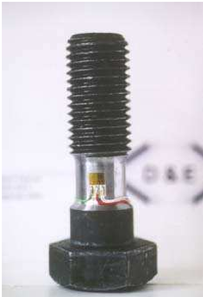
Zugkraftmessung in einer Maschinenschraube
