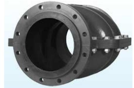
Durch Zuführung von Druckluft/Flüssigkeit (Differenzdruck min. 2 bar) in das pneumatische Quetschventil Gehäuse wird eine speziell angefertigte Manschette mit hoher Rückprallelastizität zusammengepresst. Die Konstruktion der Gehäuse garantiert ein freies lippenförmiges Schließen der Manschette. Dadurch wird ein absolut dichtes Absperren des Produktstroms und zugleich die höchste Standzeit/Lebensdauer der Manschette gewährleistet.
