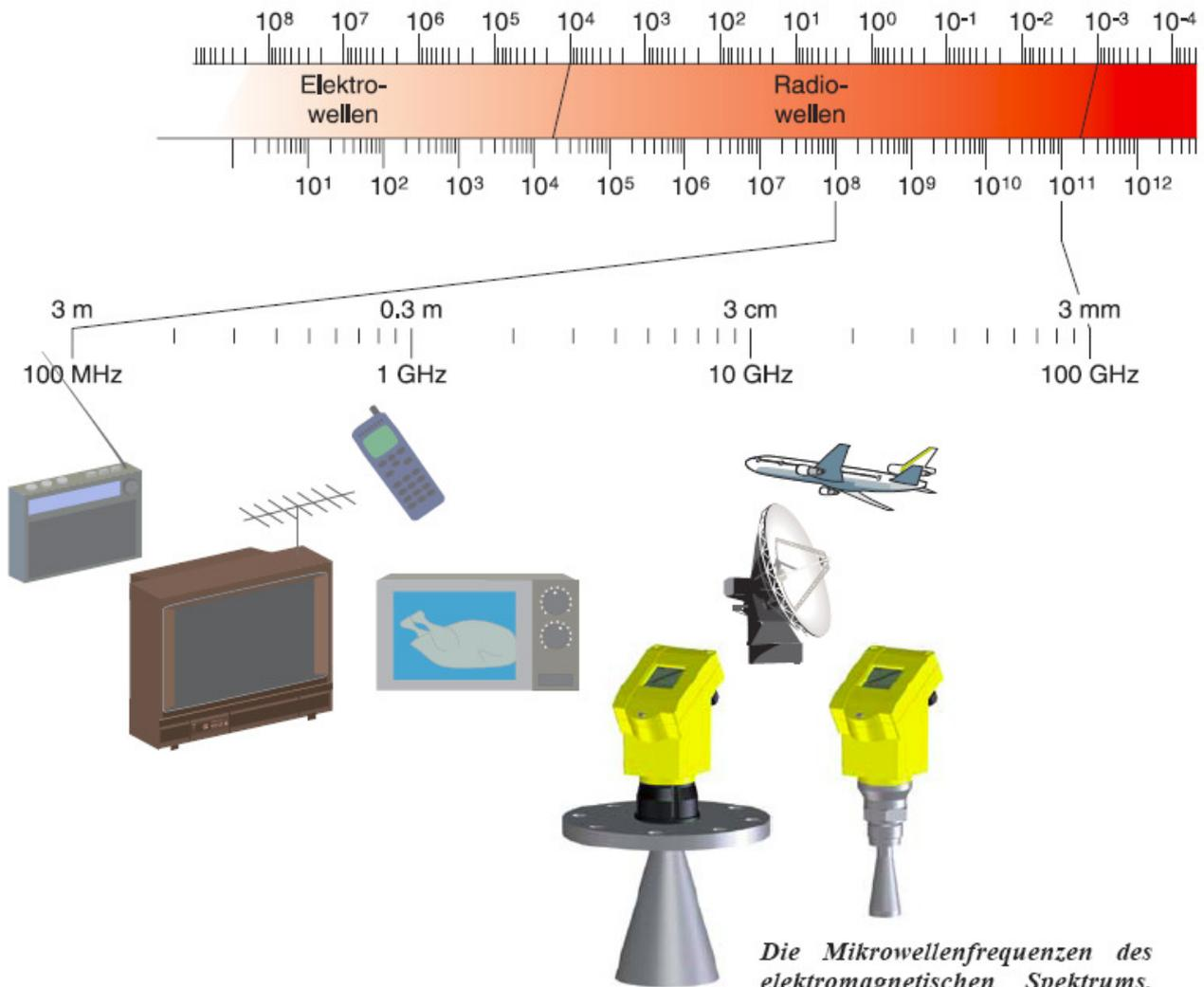
*Die Mikrowellenfrequenzen des elektromagnetischen Spektrums. Der Bereich für Radar-Füllstandmessungen liegt zwischen 6,3 GHz (4,7 cm) und 26 GHz (1,15 cm).*
