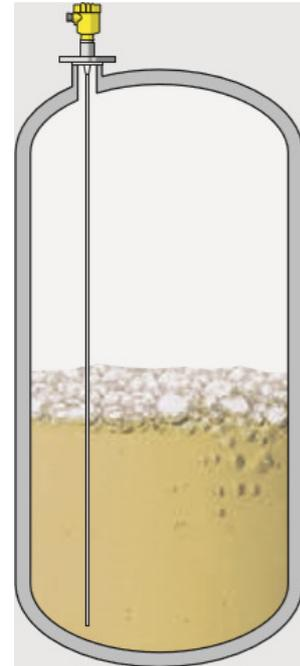
Abb. 2: Messbereiche der VEGAFLEX - Koaxialausführung
