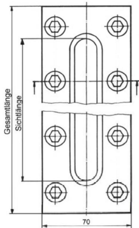
Zur Flüssigkeitsstandanzeige, Sichtkontrolle und zur Beobachtung an Behältern, Kesseln und Silos.
