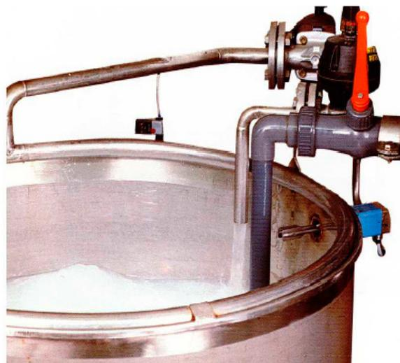
Grenzstandüberwachung mit Liquiphant-Sonden an einem Ansetzbehälter mit Rührwerk. Zuverlässige Funktion auch bei wechselnden Flüssigkeiten, unempfindlich gegen Turbulenzen, Strömungen und Schaum
