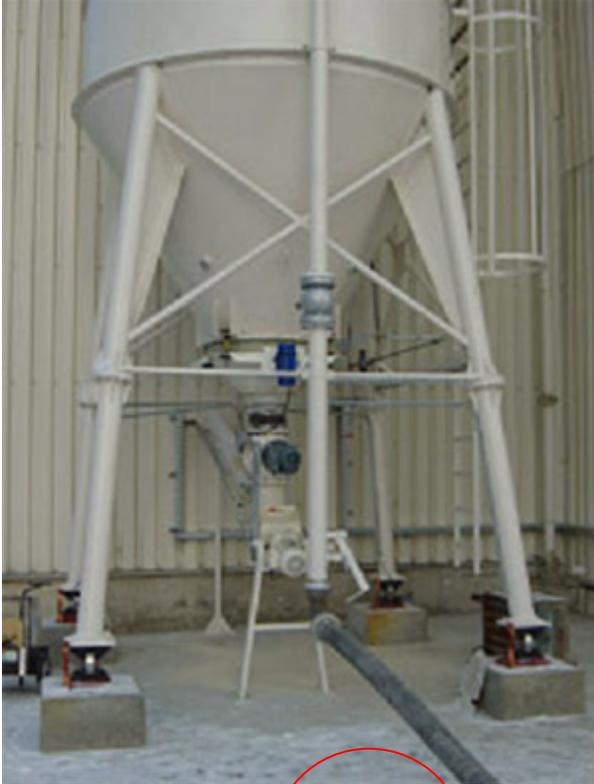
Die vom jeweiligen Niveau abhängige Gewichtskraft des Behälters, wird mittels Kraftmessdosen/ Wägezellen erfasst.
