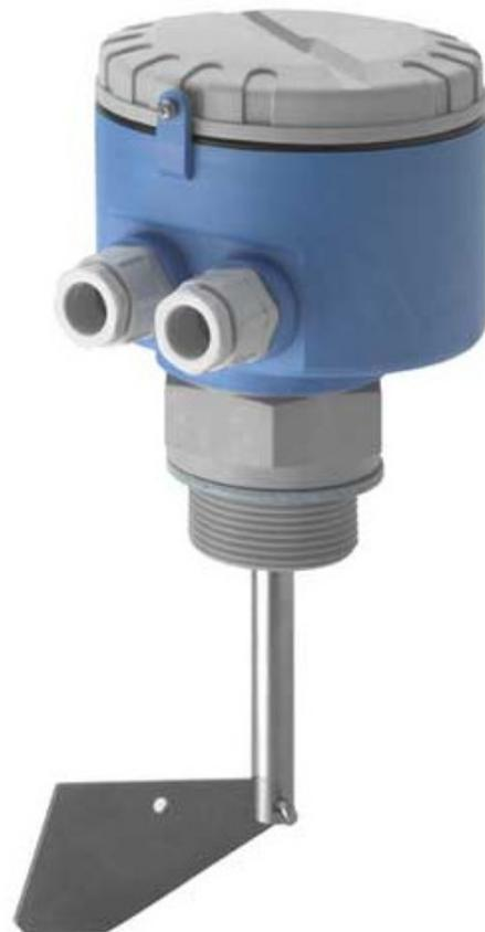
Ein Synchronmotor treibt über ein Getriebe eine Welle mit dem Messflügel an. Wird der Messflügel durch das Schüttgut gebremst oder angehalten, bewegt sich der drehbar gelagerte Motor im Gehäuse von einer Ruhe- in eine Schaltlage. Dabei werden zwei Kontakte umgeschaltet. Der erste signalisiert den Füllstand nach außen, der zweite schaltet intern den Motor ab.
