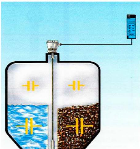
Der "Kondensator" wird gebildet aus Sonde und Behälterwand. Durch das Füllgut wird die Kapazität beeinflusst
