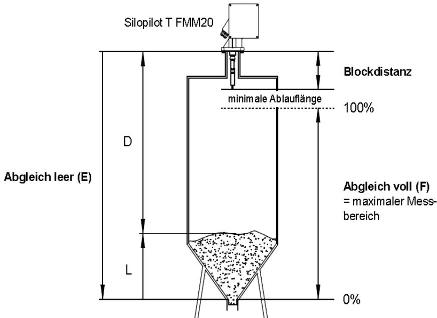
Füllhöhe (L) = Abgleich leer (E) – ermittelte Distanz Flansch zu Füllgutoberfläche (D)
