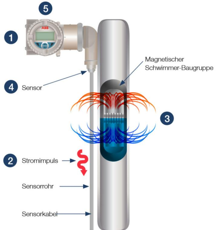
1. Die Geräteelektronik erzeugt in festen Intervallen einen Niedrigenergie-Stromimpuls.
