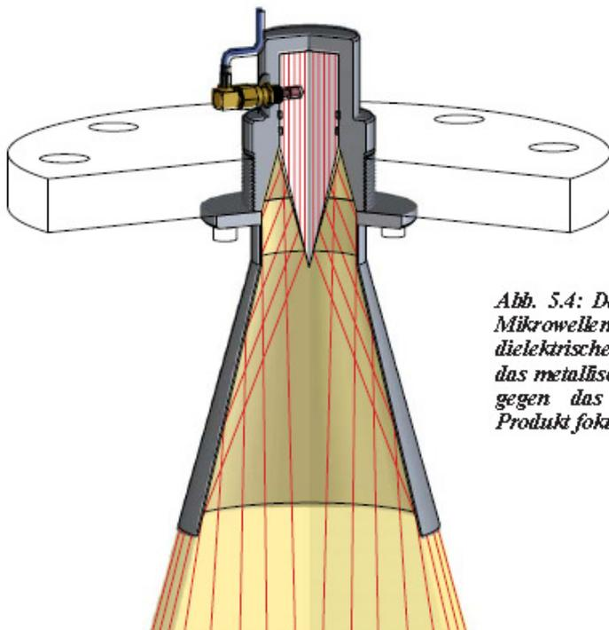
*Abb. 5.4: Der Übergang der Mikrowellen vom niedrig dielektrischen Hohlleiter in das metallische Horn, wo sie gegen das zu messende Produkt fokussiert werden.*
