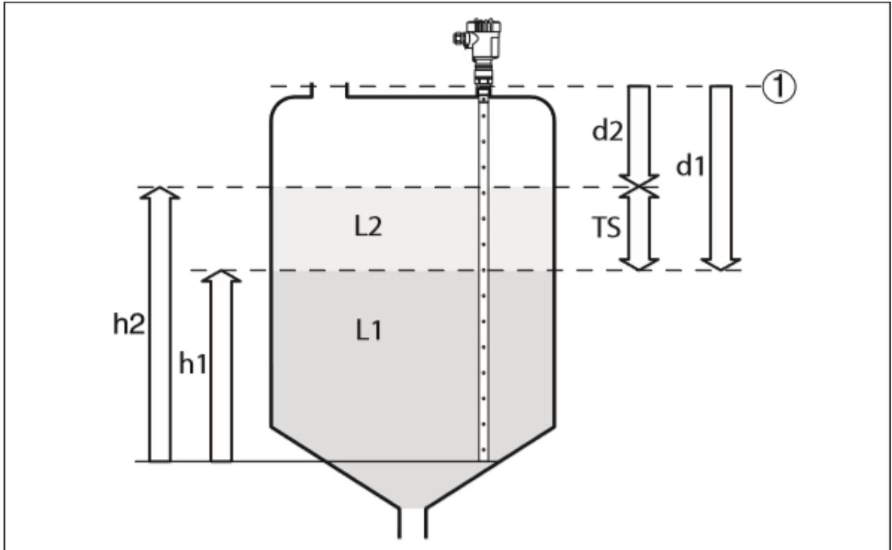
Abb. 3: Trennschichtmessung
