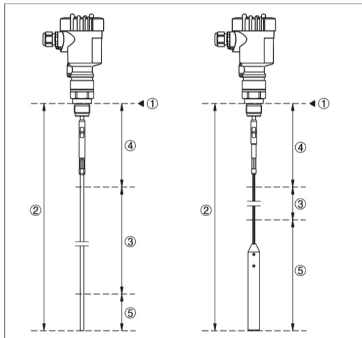
Abb. 1: Messbereiche der VEGAFLEX - Seil- und Stabausführung
