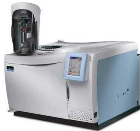
Gaschromatograph mit Tischaufbaugehäuse
