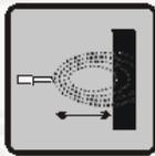
Wirbelstromsensoren tasten Metalle berührungslos und unbeeinflusst von nichtmetallischen Medien im Messraum mit einer hohen Genauigkeit ab. Schwingungstechnische Applikationen mit hohen Messfrequenzen (bis 10 kHz) können realisiert werden.
