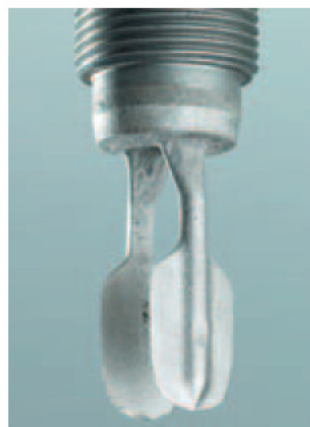
Korrosion der Schwinggabel
