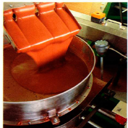
Kapazitive Füllstandmeßeinrichtung zur Niveau-Konstanthaltung an einer Nougat-Gießmaschine in einer Schokoladenfabrik
