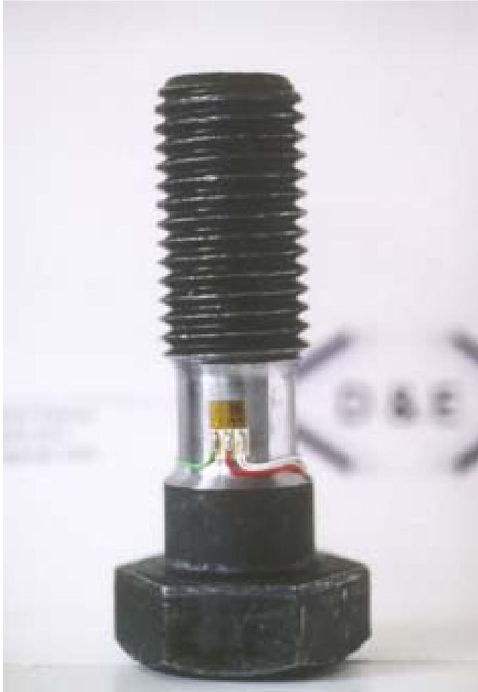
Zugkraftmessung in einer Maschinenschraube
