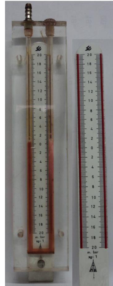
Die Abbildung zeigt ein U-Rohrmanometer-Vakuummeter.
