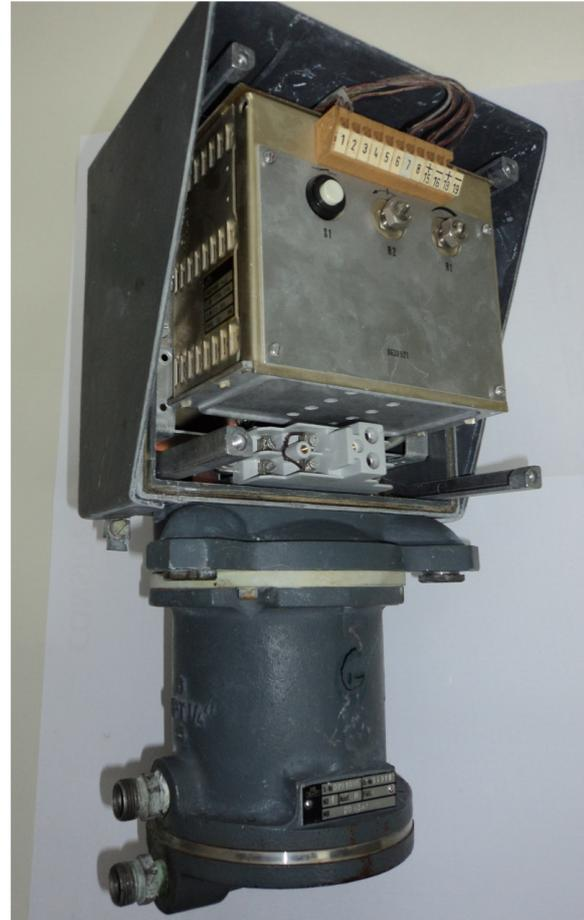
Auf die obere Kreisfläche der Glocke des Tauchglockenmeßwerkes wirkt die Druckdifferenz  $\Delta p = P_1 - P_2$
