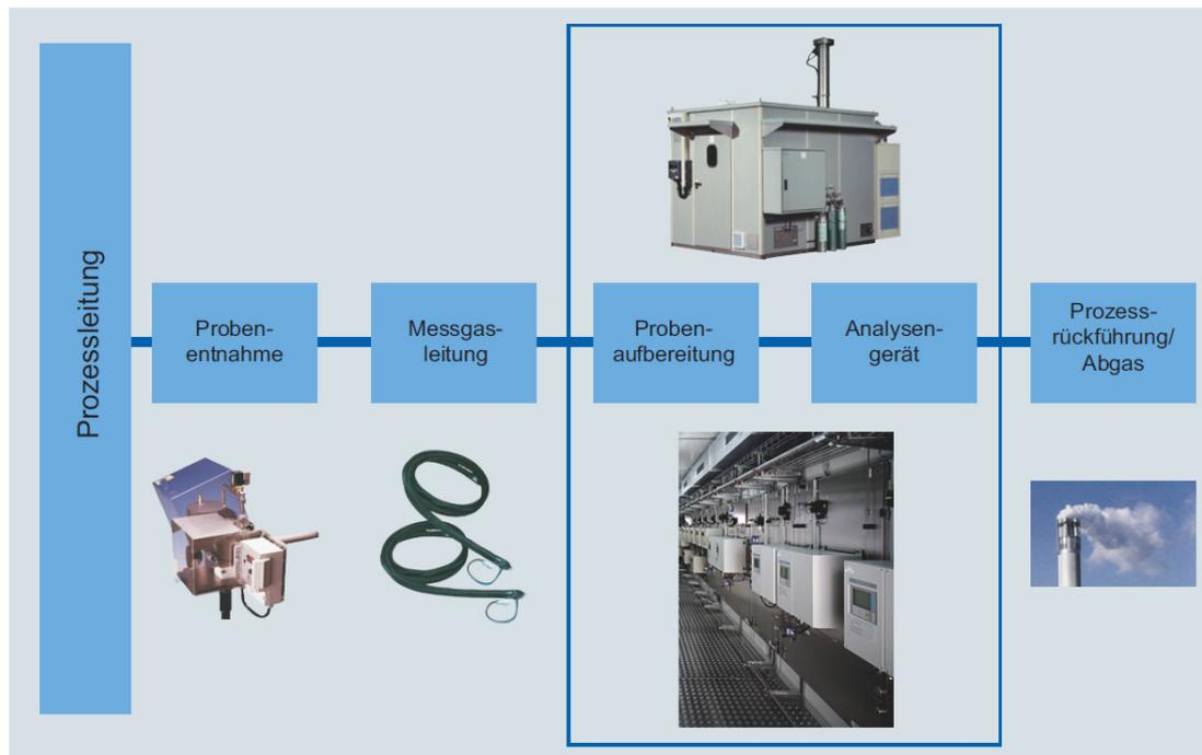
Schematische Darstellung des Messaufbaus extraktiver Messverfahren
