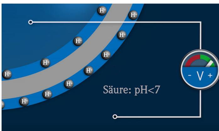
Anzahl der Wasserstoffionen der zu analysierenden Lösung (außen) größer als im Inneren der Elektrode (pH-neutrale Pufferlösung).
