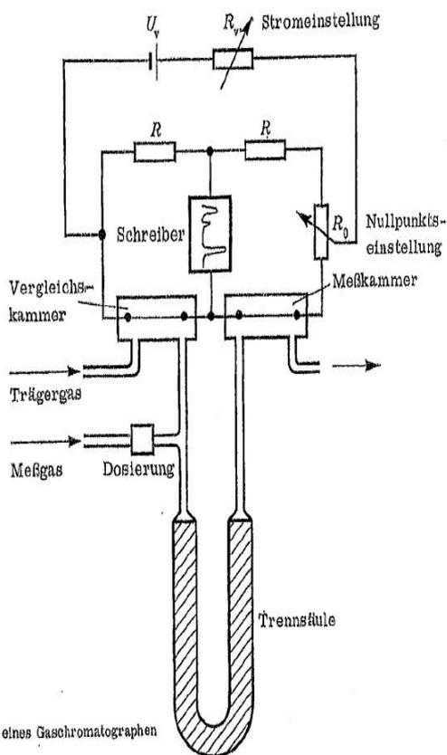
Prinzipbild eines Gaschromatographen (Siemens)
