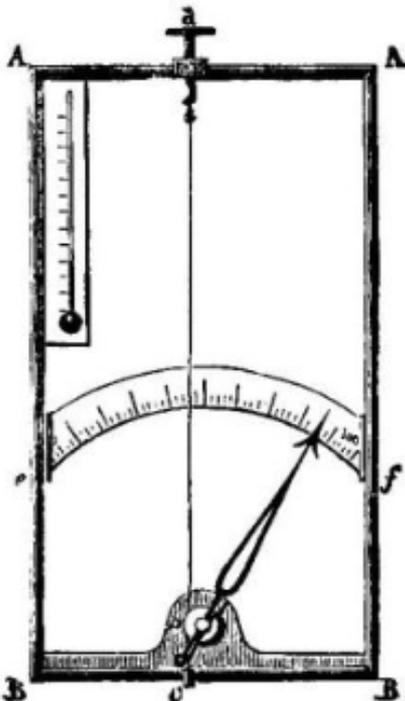
Die durchschnittliche Längenausdehnung eines Haares beträgt 2,5%, wenn die Luftfeuchtigkeit sich um 10% ändert. Das heißt: Ein 100mm langes Haar, kann eine maximale Länge von 102,5mm annehmen.
