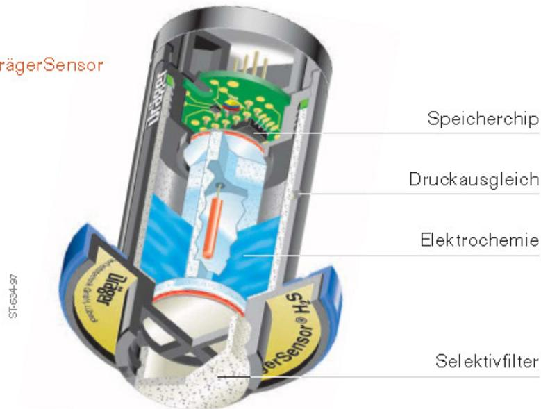
Elektrochemische Sensoren funktionieren ähnlich wie Batterien. Bei Anwesenheit des Zielgases wird chemisch zwischen zwei Elektroden eine kleine elektrische Leistung erzeugt und im Gasmesskopf zur Anzeige gebracht. Die Signalgröße ist proportional zur Konzentration.
