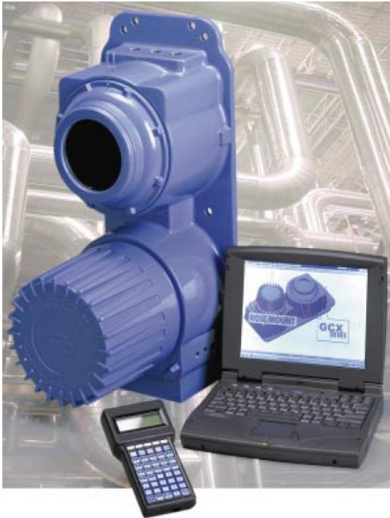
Im GCX Transmitter kommen zwei unterschiedlich funktionierende, miniaturisierte Detektorsysteme zum Einsatz. Eine Mikro-Wärmeleitfähigkeitsmesszelle (**Mikro WLD**) nutzt als Messgröße die Widerstandsänderung eines dünnen beheizten Drahtes. Aufgrund der Abkühlung des Drahtes durch das von der Trennsäule in den Detektor strömende Gas wird dieser Messeffekt erzeugt.
