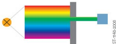
Nur der grüne Anteil des eingestrahlt Lichts wird herausgefiltert und dessen Intensität gemessen.
