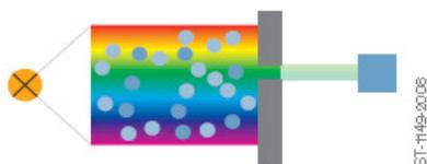
Absorbiert ein Gas den grünen Anteil des eingestrahlt Lichts, so ist dessen Intensität messbar reduziert.
