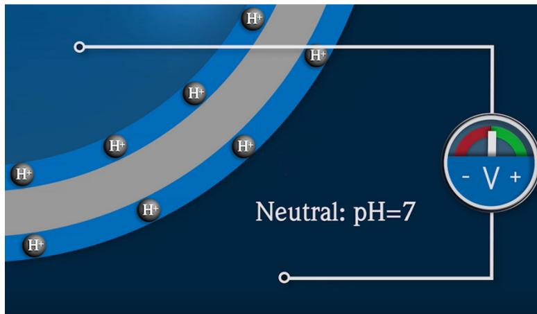
Anzahl der Wasserstoffionen der zu analysierenden Lösung (außen) gleich groß als im Inneren der Elektrode (pH-neutrale Pufferlösung).
