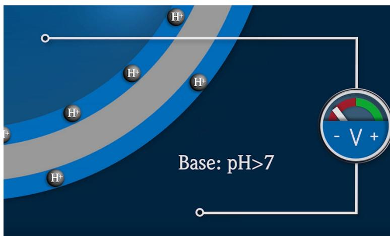
Anzahl der Wasserstoffionen der zu analysierenden Lösung (außen) kleiner als im Inneren der Elektrode (pH-neutrale Pufferlösung).
