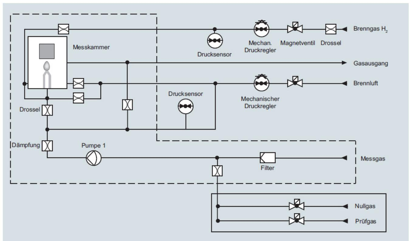
Gesamtkohlenwasserstoff-Gasanalysegerät FIDAMAT 6, Gaslauf mit Pumpe und mit Anschluss für Brennluft
