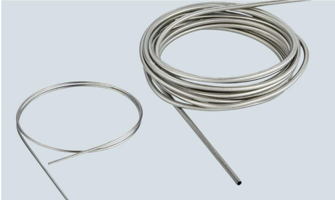
Das Herzstück des Gaschromatographen: Die Trennsäule (in der Abbildung sieht man eine mikrogepackte und eine gepackte Trennsäule - von links nach rechts)
