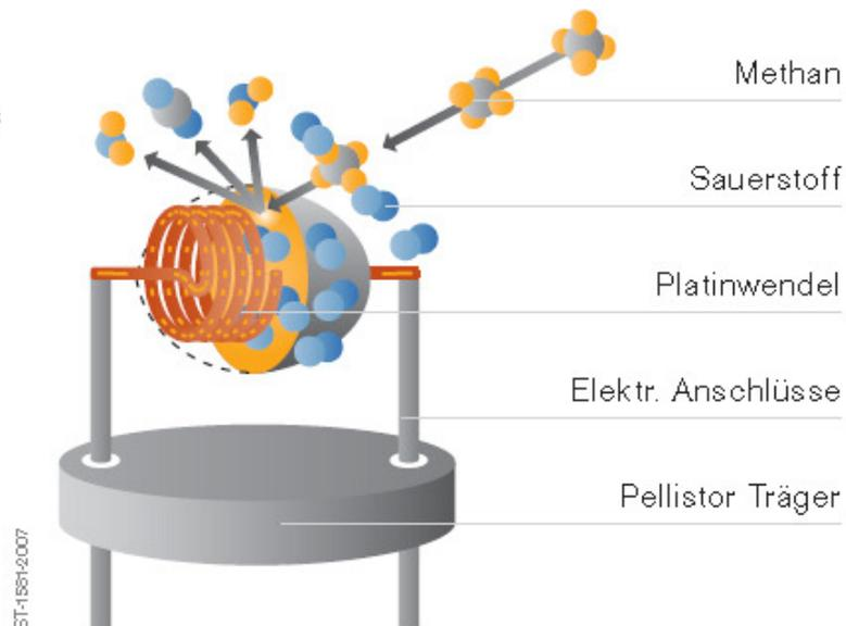
Wie misst man brennbare Gase? Ganz einfach – man verbrennt sie. Aber natürlich nicht mit offener Flamme, denn sie sollen schon detektiert werden, bevor sie ein brennbares Gemisch mit Luft bilden.
