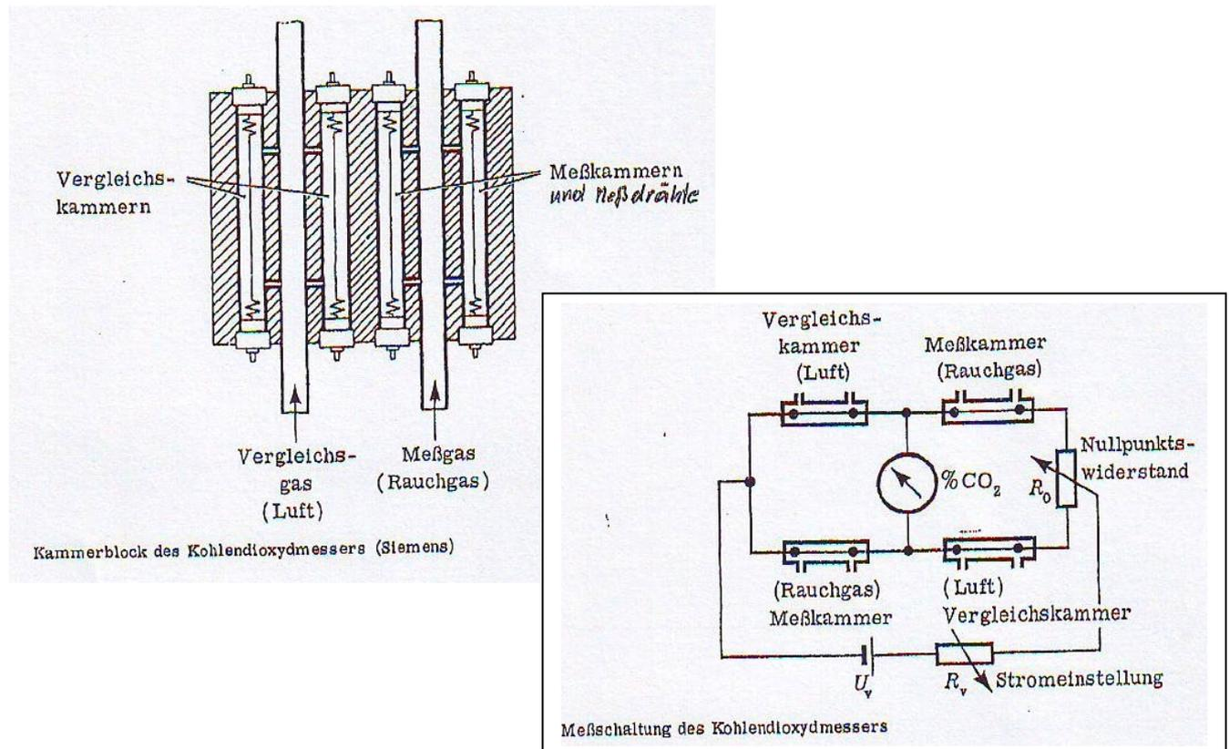
Als Messschaltung wird eine Wheatstonesche Brücke benutzt, deren Brückenwiderstände als Platindrähte ausgebildet sind. Je zwei dieser geheizten Messdrähte befinden sich in Kammern, die mit dem Messgas (Rauchgas) bzw. mit dem Vergleichsgas (Luft) gefüllt sind.
