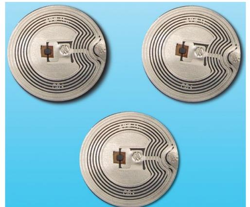
Man unterscheidet dabei zwischen den so genannten Close Coupling Tags, bei denen eine direkte Interaktion erforderlich ist um auf die gespeicherten Daten zuzugreifen, und den Remote Coupling Tags, die im Entfernungsbereich von etwa 1 m aktiviert werden können.
