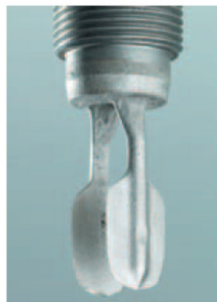
Korrosion der Schwinggabel
