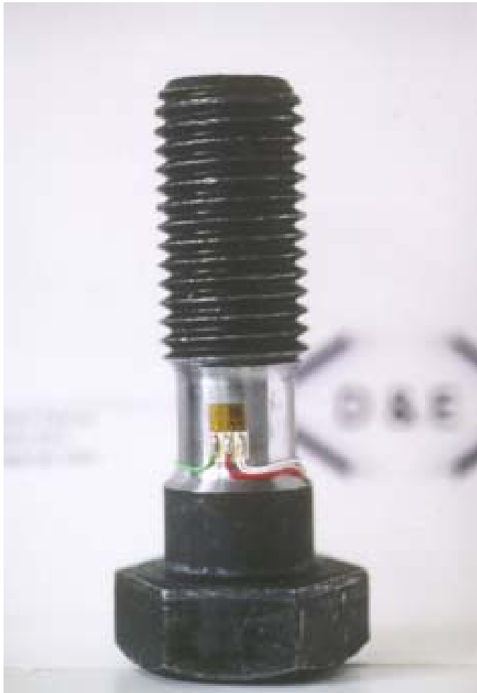
Zugkraftmessung in einer Maschinenschraube
