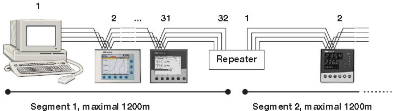
Einsatz eines Repeaters bei einer RS-422-Schnittstelle
