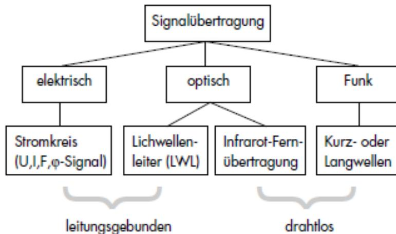
Für die serielle Datenübertragung stehen ganz verschiedene Übertragungsmedien zur Verfügung. Dabei werden die Signale elektrisch, als Lichtpulse oder per Funk übertragen. Zur Auswahl eines geeigneten Mediums sind verschiedene Aspekte zu bewerten:
