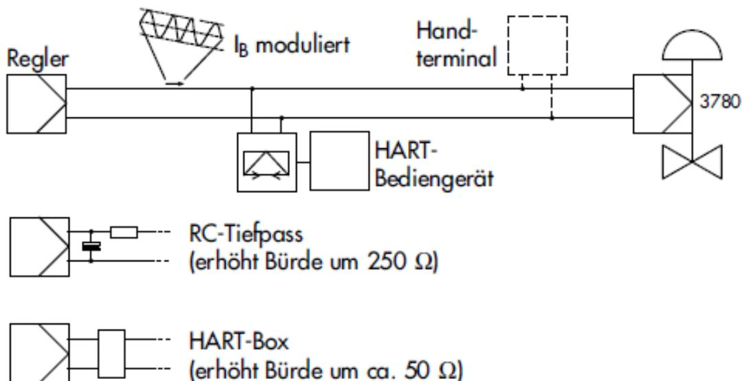
Der im Bild dargestellte RC-Tiefpass (250 W, 1 mF) erfüllt diese Funktion. Nachteilig ist jedoch der in Reihe liegende Widerstand, den der Reglerausgang als zusätzliche Last treiben muss.
