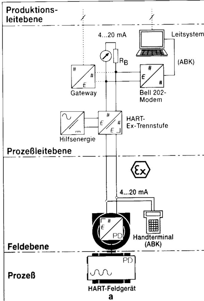
In jeder HART-Zusammenschaltung sind zwei Anzeige-Bediengeräte (ABK's, Anzeige-Bedienkomponenten) zugelassen:
