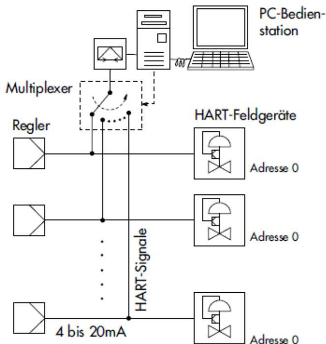
Der Benutzer wählt per Bedienprogramm eine Stromschleife zur Kommunikation aus. Für die Dauer der Kommunikation verbindet der Multiplexer diese Stromschleife mit der Bedienstation. Durch eine kaskadierte Multiplexerstruktur kann man mit sehr vielen (> 1000) Geräten, alle adressiert auf Adresse Null, kommunizieren.
