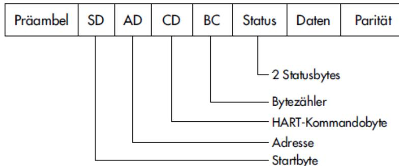
Jede von einem Feldgerät auszuführende HART-Anweisung erfordert eine spezifische Größe des Datenteils. Der Bytezähler gibt jeweils die Zahl der nachfolgenden Status- und Datenbytes an.
