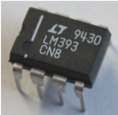
LM 393 mit 2 Komparatoren (Quelle: www.conrad.de )
