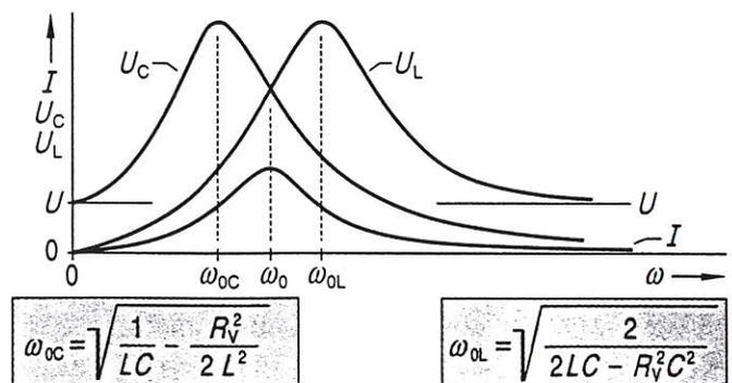
**Dämpfung im Parallelschwingkreis**
