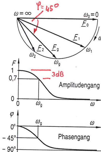
Darstellung in zwei Frequenzkennlinien (Bode-Diagramm)
