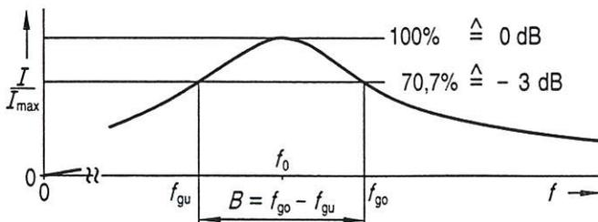
● Die Bandbreite einer Resonanzkurve ist die Differenz zwischen ihrer oberen und unteren Grenzfrequenz
