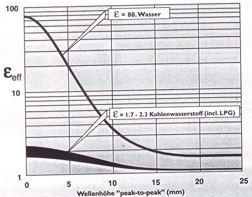
Messungen auf einer turbulenten Wasserfläche mit 15 mm hohen Wellen entspricht Messungen auf einer ruhigen Fläche eines Kohlenwasserstoffes.
